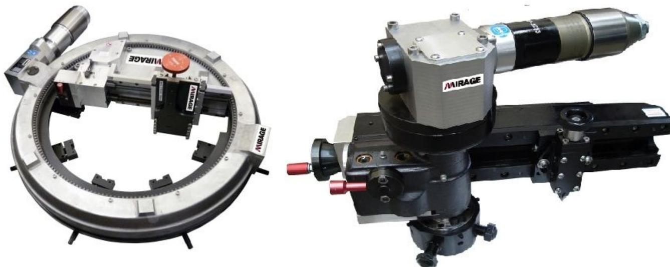
Рис. 14. Мобильные станки для обработки фланцев труб [51, 52]
